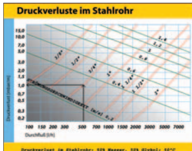
Abb. 5.9 Druckverlust in Stahlrohren; Grafik: ASIc; Quelle: [2]
