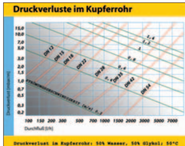
Abb. 5.8 Druckverlust in Kupferrohren; Grafik: ASIc; Quelle: [2]
